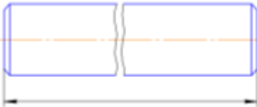
Рис. 3.9. Розмірна лінія на зображенні з розривом
